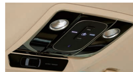
Ovládací panel nad hlavou řidiče a spolujezdce, dotykové ovládání osvětlení interiéru, signalizace nezapnutí bezpečnostních pásů
