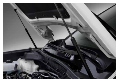
Kapota podepřená plynovými vzpěrami
