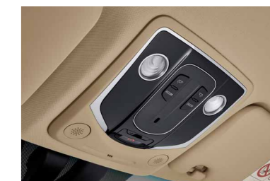
Ovládací panel nad hlavou řidiče a spolujezdce s dotykovým ovládáním vnitřního osvětlení a střešního okna
