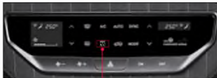
Spínač klimatizace vzadu
