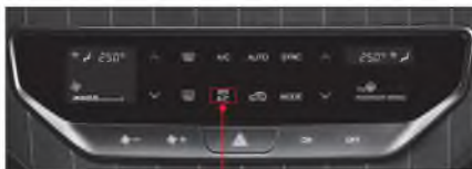
Spínač klimatizace vzadu
