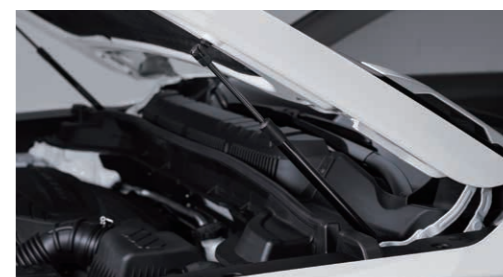
Podpěry kapoty se vzduchovými tlumiči
